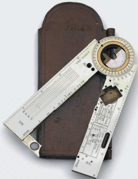
Polymeter, universales Meßinstrument im Taschenformat. Gefertigt von Dominikus Mauch um 1857
