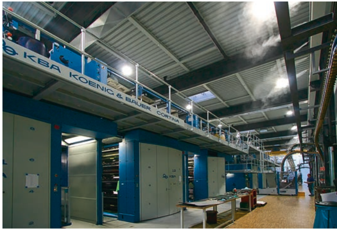
Blick in das 2006 fertiggestellte neue Druckhaus mit der wasserlosen Offset-Rotationsmaschine »Cortina« von Koenig & Bauer (Foto: BZ-Archiv)
