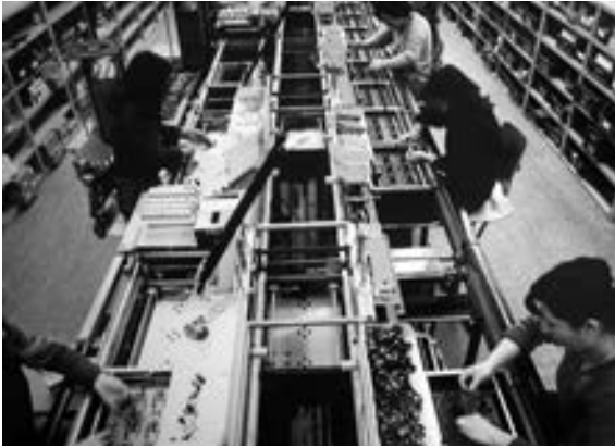
Abb. 10: Bestückungslinie für Bildrohrplatten und Pal-Decoder.
